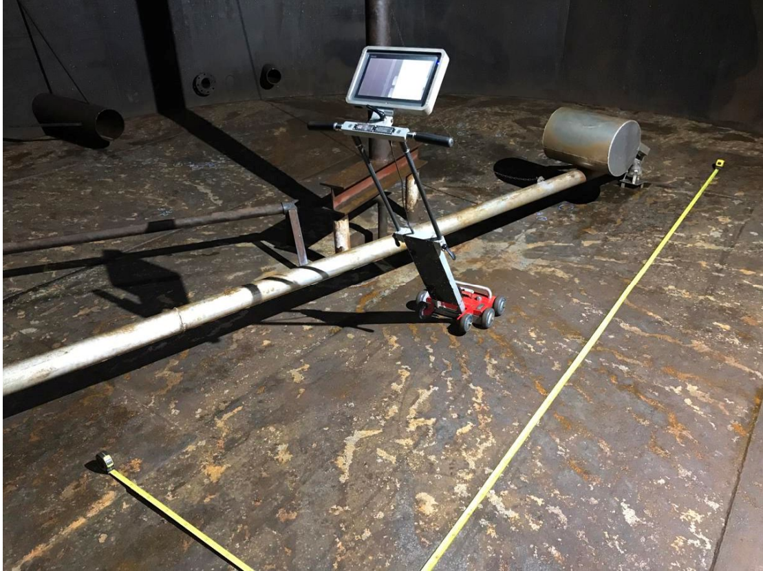
Mynd 3. Gólf er alsett tæringu
