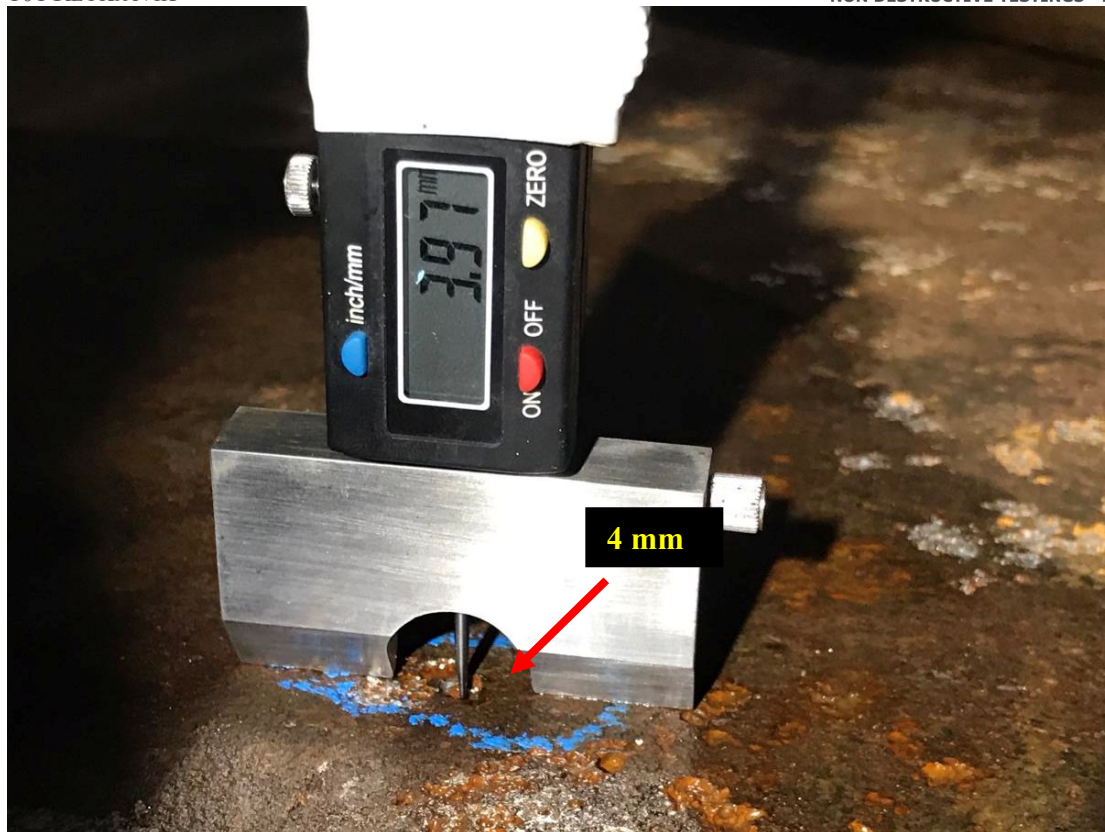
Mynd 5. Pyttur sem mældist 4mm djúpur á c.a 6,5mm þykkri plötu.
