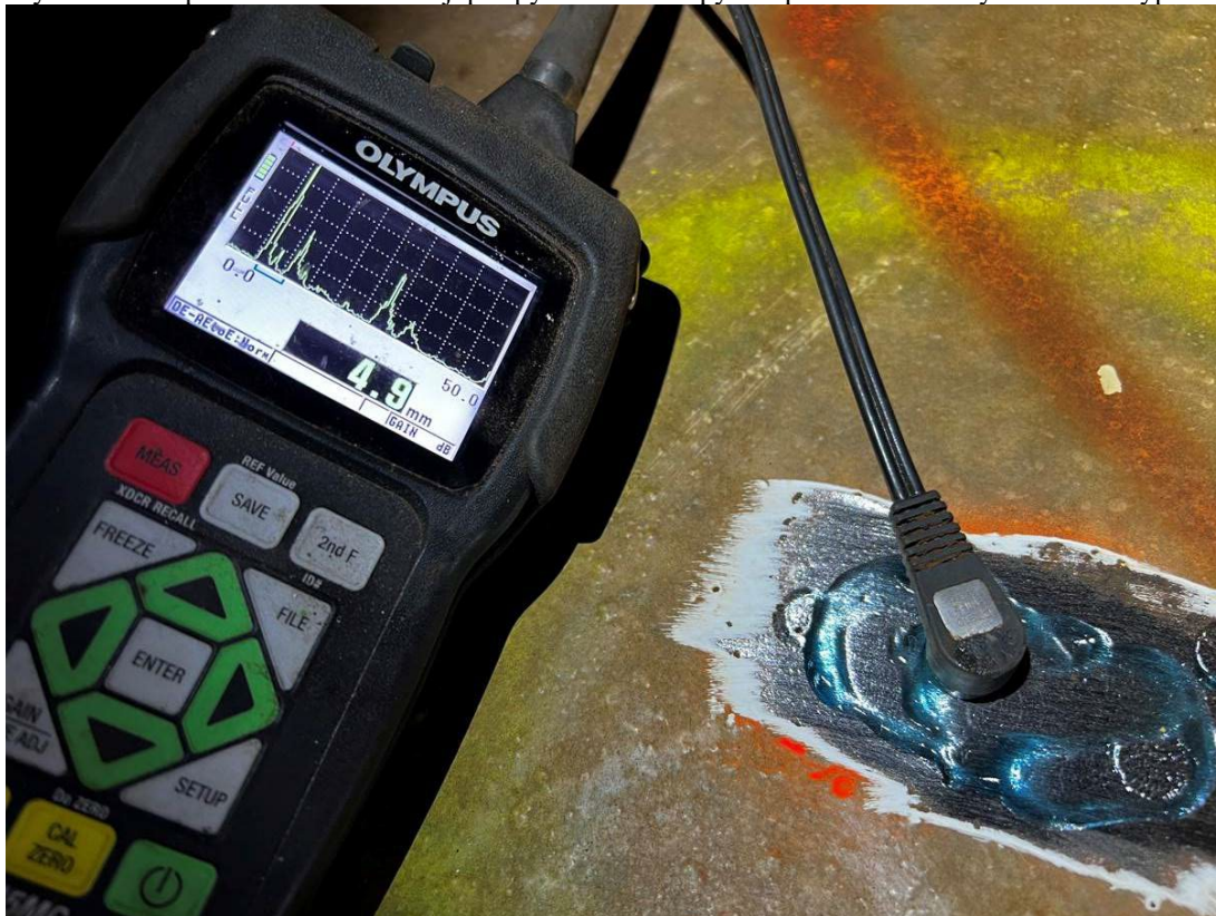
Mynd 7. Í plötu 67 kom fram á skanna tæring. Kannað með þykktarmæli. Efnisþykkt 4.9mm.
