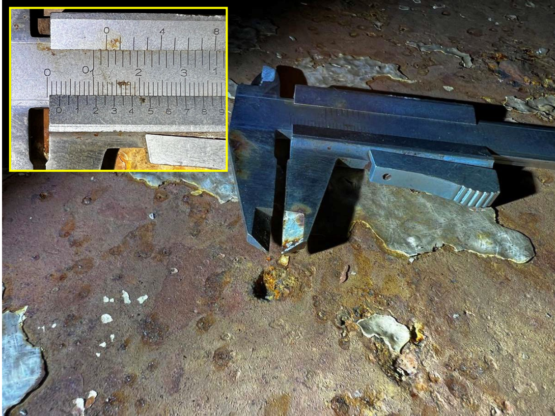
Mynd 5 & 6. Í plötu 45 fannst einn djúpur pyttur í 6.3mm þykkri plötu. Skíðmál sýnir 2.7mm dýpt.
