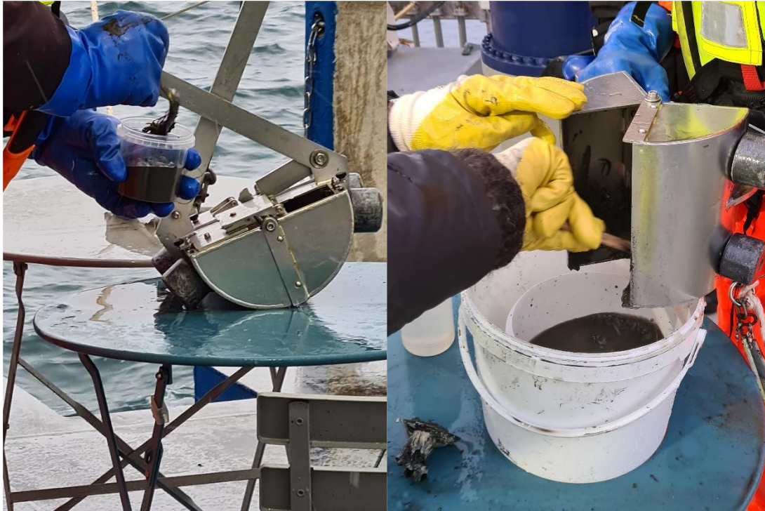
Mynd 2-2. Sýni eru tekin með Van Veen greip.
